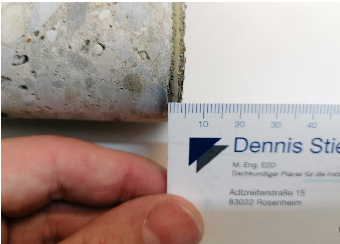
Abb. 39 Nahaufnahme des Schichtaufbaus OS11.b am Bohrkern BK 02
