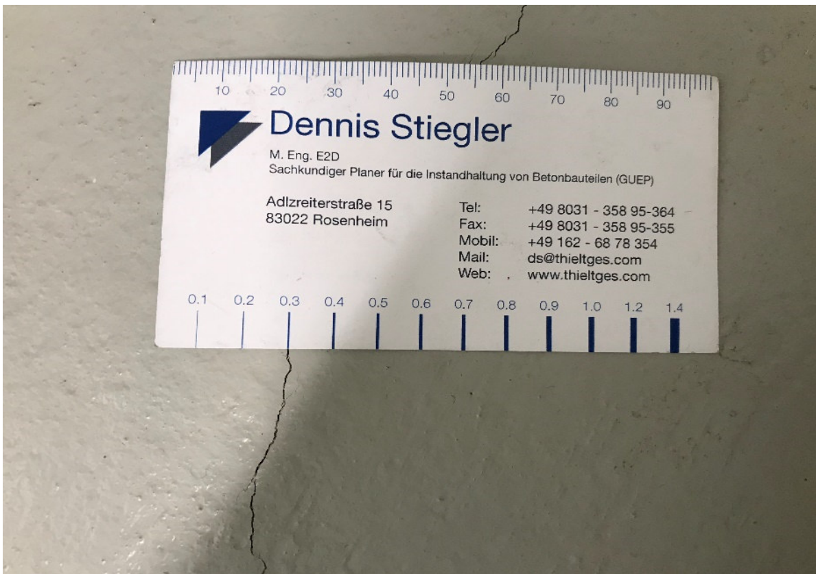
Abb. 10 Rissbreitenmessung mittels Rissbreitenlineal an der Bodenplatte, Rissbreite ca. 0,3mm
