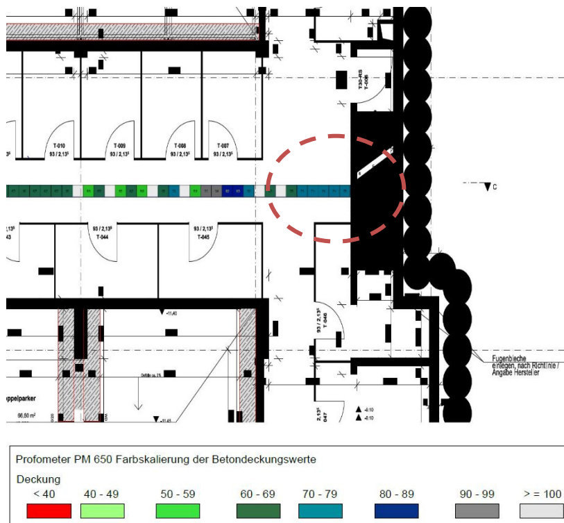
Abb. 26 Planauszug der Betondeckungsmessung [A] 12 mit Farbskala
