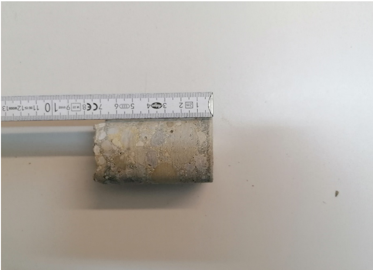
Abb. 18 Vermessung Bohrkerns BK06, Maß der Betondeckung bis zur Bewehrung ca. 75mm
