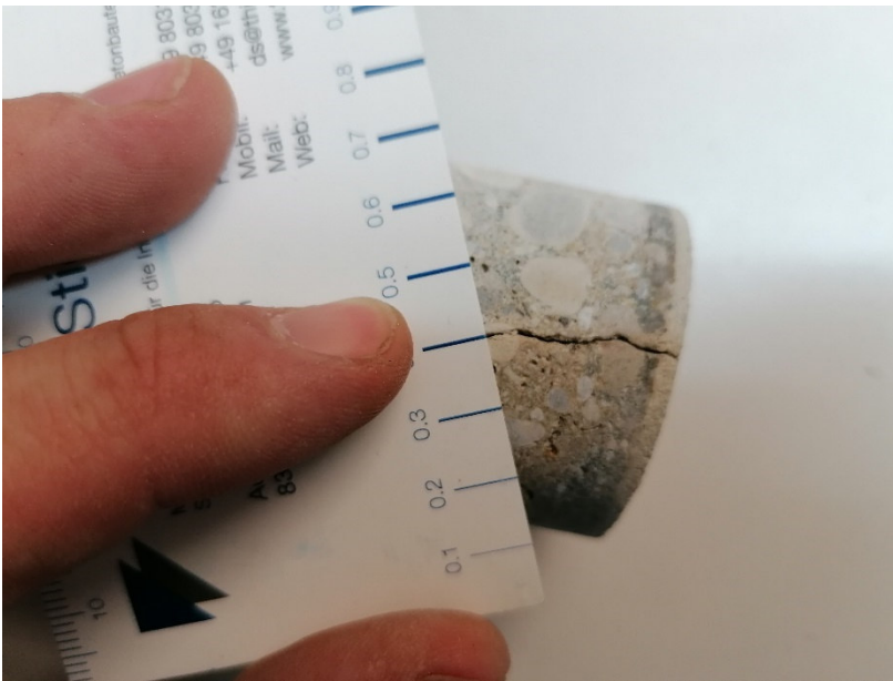
Abb. 17 Rissbreitenmessung an Bohrkern BK06 mit Rissbreiten bis zu ca. 0,4mm, Risstiefe ca. 75mm
