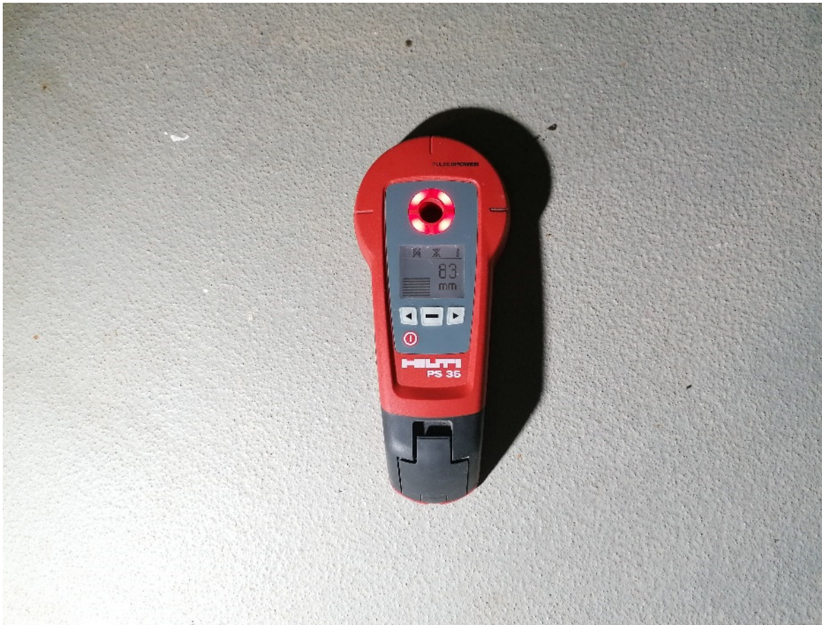
Abb. 28 Betondeckungsmessung am orientierenden Ortstermin vom 01.02.2024 mit Handgerät Hilti PS 35
