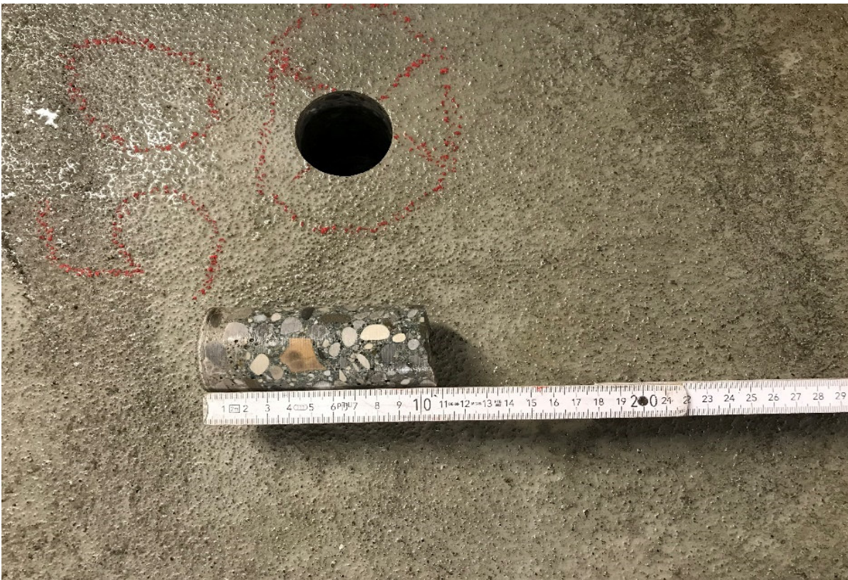
Abb. 30 Bohrkern BK05, gemessene Betonüberdeckung 10cm
