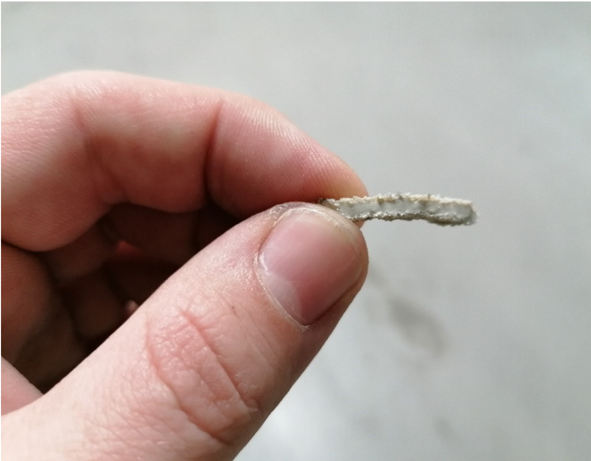
Abb. 43 Ausbruchstück der OS 11b Beschichtung, mit klar erkennbarer Einstreu- u. dünner Quarzsandschicht
